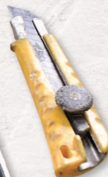
美工刀 用以將PU發泡塊 切割成形體。
