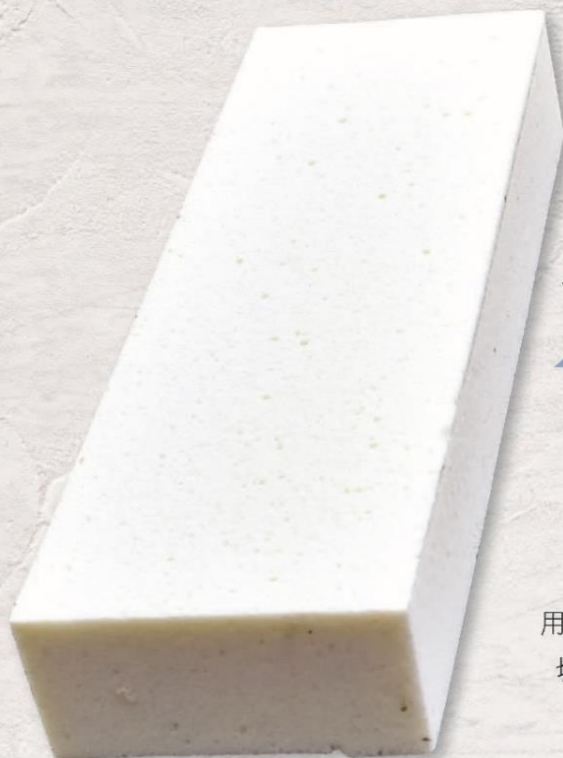
PU發泡塊 (密度60%) 作為作品的形體材料。
